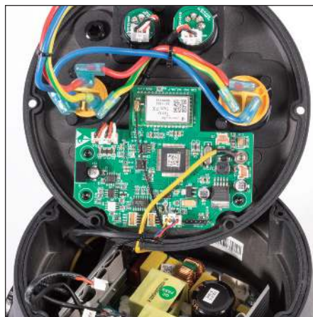
Anschlussterminal, Steuerplatine und Netzteil im hinteren Teil
