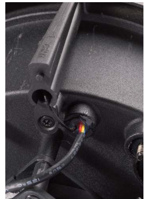
Antenne für W-DMX versteckt in einer Kunststoffhülle, im Design einer Kühlrippe
