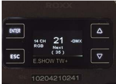
Menübedienung Beleuchtete Touch-Tasten und übersichtliches Grafikdisplay
