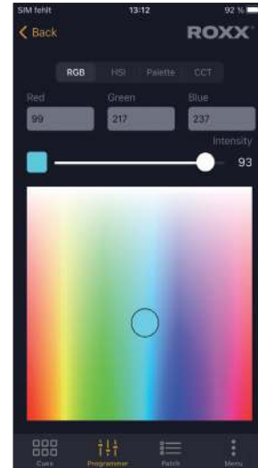
App für iPhone/iPad ersetzt die Fernbedienung via Bluetooth wird ein Device verbunden, das weitere Geräte via DMX oder WDMX mitsteuert
