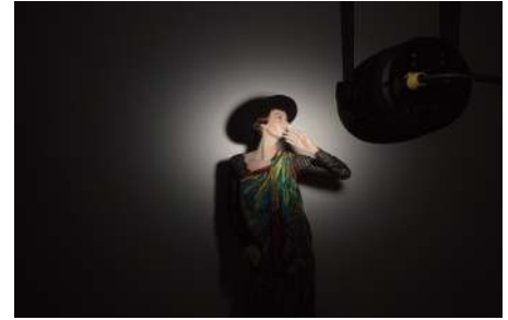
Lichtbild der schmalen asymmetrischen Linse (EN) – Der Abstand zur Wand ist zum Vergleich gleichgeblieben
