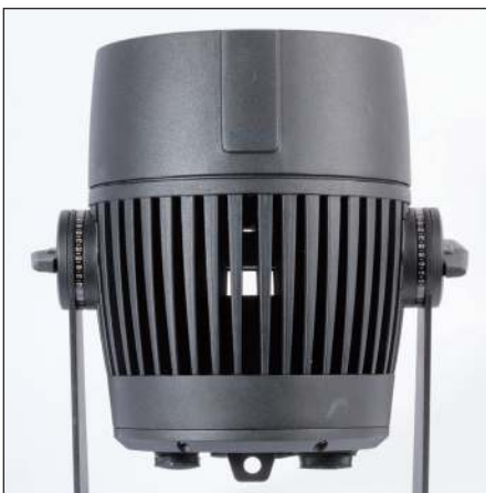
Dreigeteilt Vordere Kammer oben mit dem Reflektor, der LED und dem LED-Treiber-Board, der offene mittlere Teil, der hauptsächlich von den Kühlrippen gebildet wird, für die Kühlung mit Lüfter. Das letzte Drittel ist die hintere Kammer mit Anschlussterminal, Steuerplatine und Netzteil
