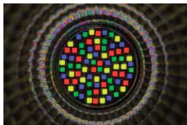
FC (Full Color) aus 20 roten, 20 grünen, 20 blauen und 20 Lime-LEDs und deren zugehörige Spektren
