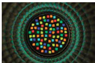
LEDs im TW+ 10 rote, 10 grüne, 10 blaue, 20 Amber, 10 Cyan und 20 Lime und das zugehörige Spektrum
